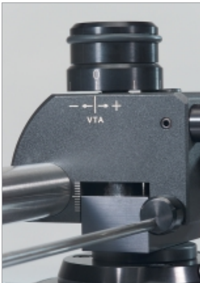
Höhenverstellung à la Kuzma: Eine Drehung von 45 Grad bringt 0,1 mm
