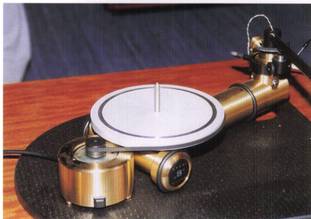
圖中銀白色的圓碟就是內轉盤，如要改變轉速，只需加上45轉用塑膠滑輪(pulley)於原來pulley上便可。
