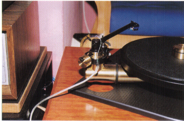
圖中可見臂管自臂管頂部伸出，經過油兜後的特設管位再伸延，保證不會影響唱臂循跡。
