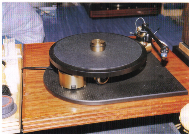
分體式馬達最好放在唱盤「七點鐘」位置，將磁場影響減至最低。
